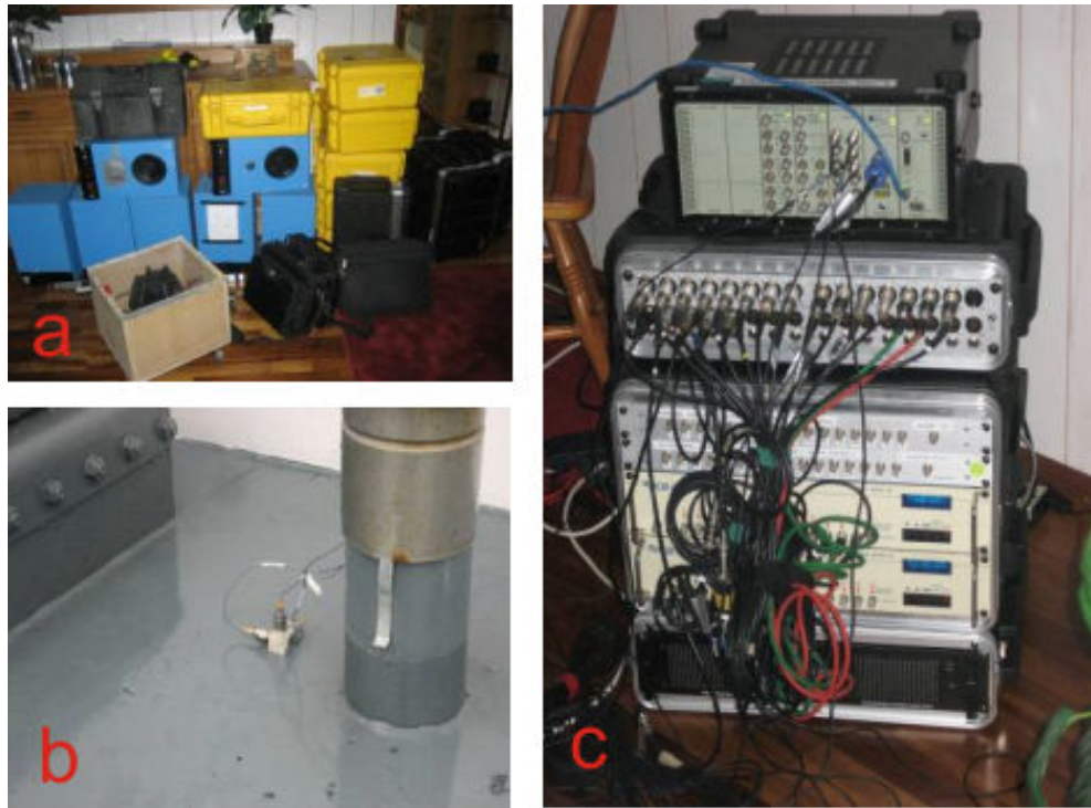
Figuur 4.1: Fotoserie op de ***** a) Meetapparatuur aan boord, b) B&K versnellingsopnemers op het dek bevestigd, c) ANC Controller, PULSE met voorversterkers en vermogensversterker voor subwoofer
